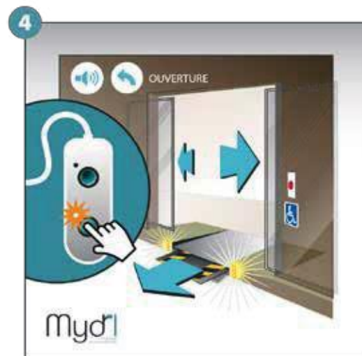
4 - La rampe arrive en fin de course, la porte s'ouvre.
