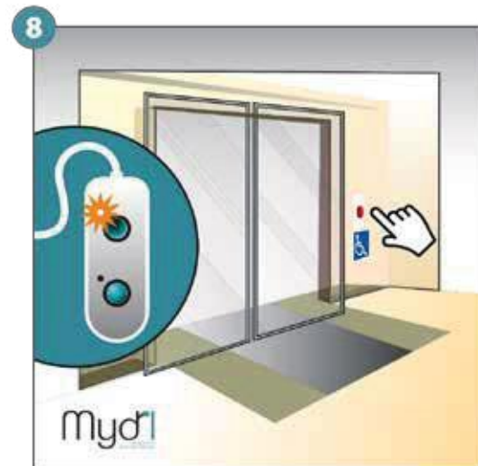
8 - Bouton d'appel à l'intérieur pour la manoeuvre d'ouverture de la rampe et de la porte.
