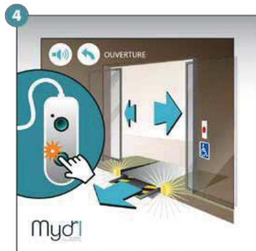
4 - La rampe arrive en fin de course, la porte s'ouvre. Maintenir la pression jusqu'à l'éclairage du voyant de fin de course.
