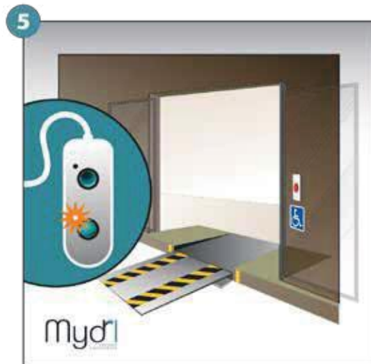
5 - Porte ouverte et rampe en service.
