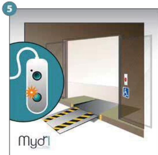
5 - Porte ouverte et rampe en service.
