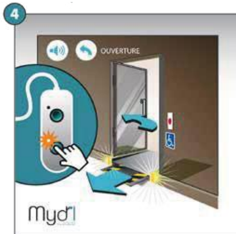
4 - La rampe arrive en fin de course, la porte se déverrouille et s'ouvre.
