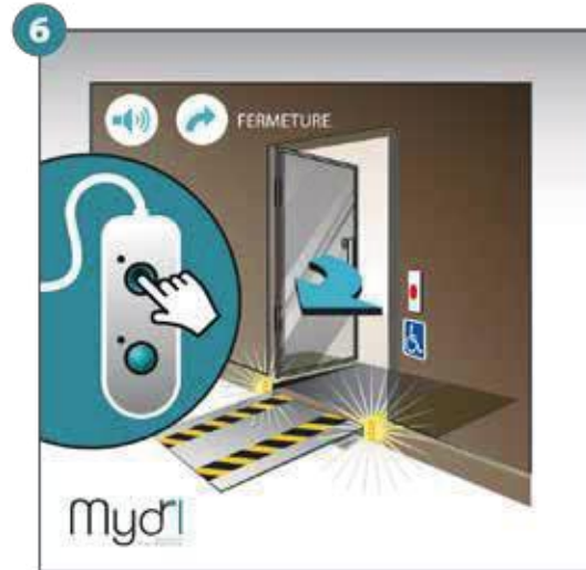
6 - Fermeture et verrouillage de la porte, début de la fermeture de la rampe. Signal sonore et visuel actif. Appuyer sur le bouton haut en pression maintenue.
