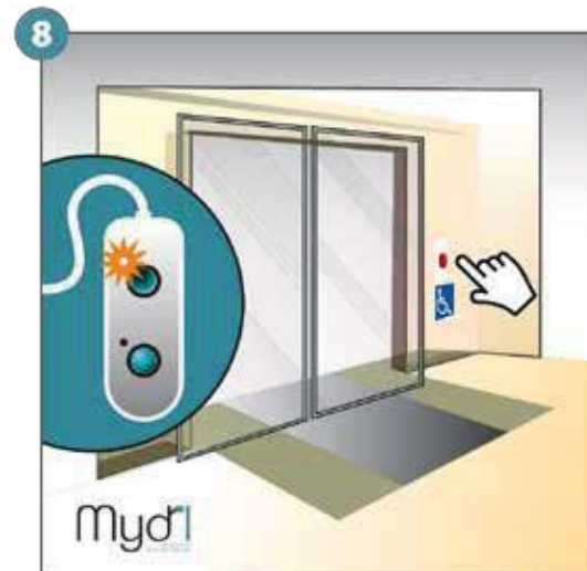
8 - Bouton d'appel à l'intérieur pour la manoeuvre d'ouverture de la rampe et de la porte.
