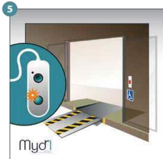
5 - Porte ouverte et rampe en service.
