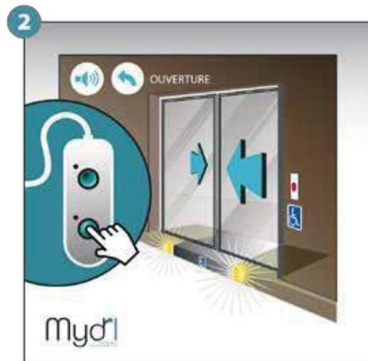
2 - Mise en route du signal sonore et visuel. Depuis le boîtier de commande à l'intérieur, appuyer sur le bouton bas en pression
