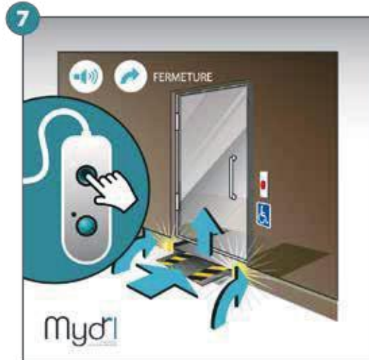
7 - Une fois la porte fermée, repli de la rampe avec un signal sonore et visuel, puis déverrouillage de la porte.
