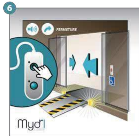
6 - Fermeture de la porte et début de la fermeture de la rampe. Signal sonore et visuel actif.
