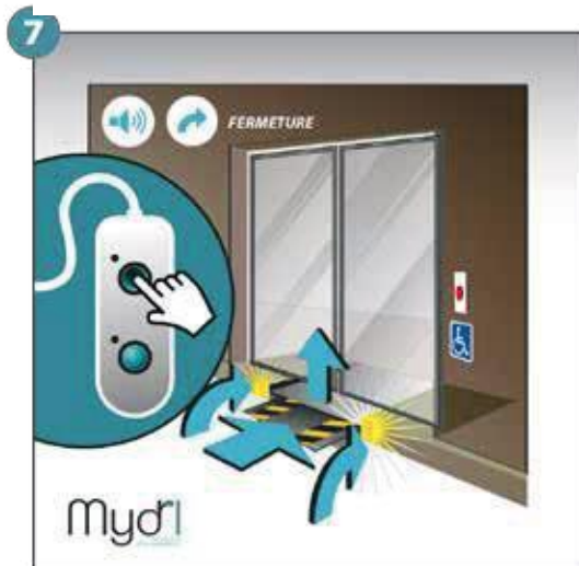
7 - Une fois la porte fermée, fermeture de la rampe avec un signal sonore et visuel.
