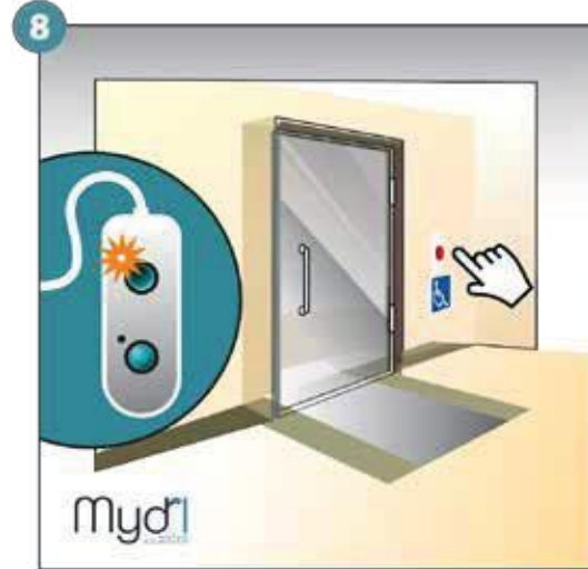
8 - Bouton d'appel à l'intérieur pour la manoeuvre de la rampe et de la porte.
