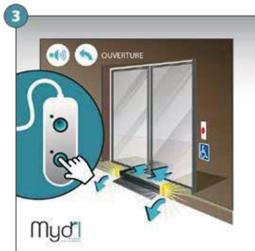
3 - Ouverture du volet et sortie de la rampe Depuis le boîtier de commande à l'intérieur, appuyer sur le bouton bas en pression
