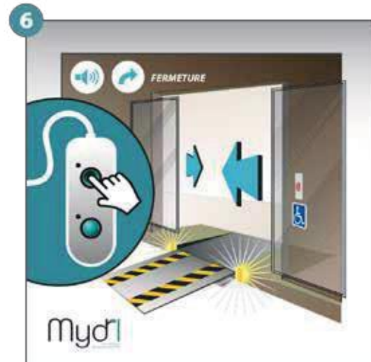
6 - Fermeture de la porte et début de la fermeture de la rampe avec signal sonore et visuel.
